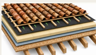
CUBIERTA TRADICIONAL MALLORQUINA
